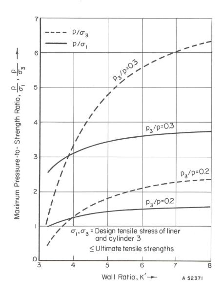
FIGURE 24. EFFECT OF SUPPORT PRESSURE P3 ON BORE PRESSURE CAPABILITY FOR THE RING-FLUID-SEGMENT CONTAINER
